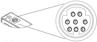
Standard 8 Pin Mini-DIN Pin-Out
