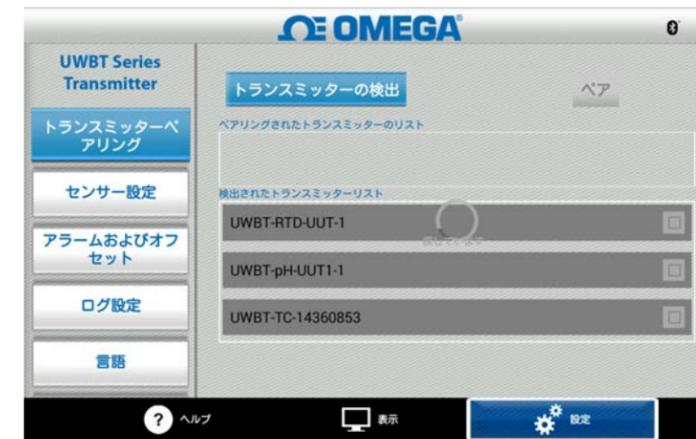
5. [Discovered Devices (検出されたデバイス)] リストで、ペアリングしたいトランスミッタを選択します。
