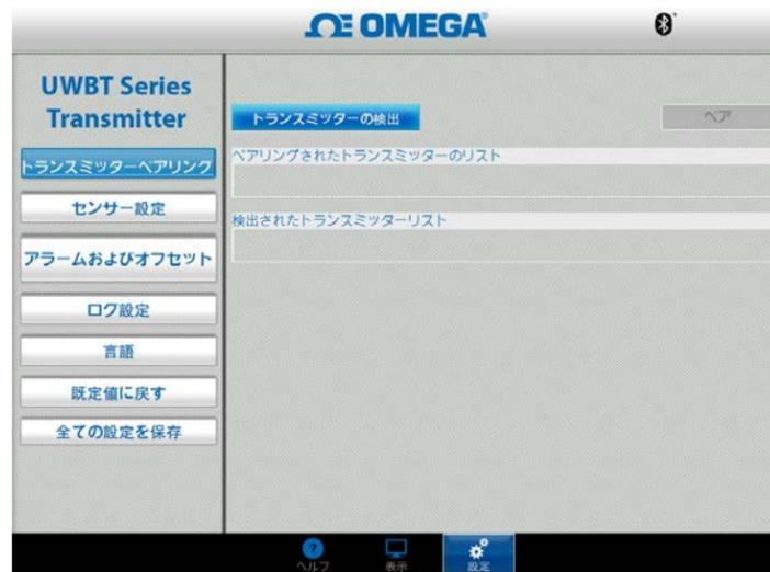
4. [Discovered Devices (検出されたデバイス)] リストで、ペアリングしたいトランスミッタを選択します。
