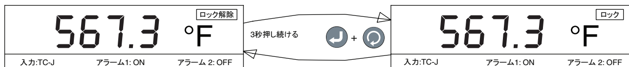
図9 ロック/ロック解除フローチャート
