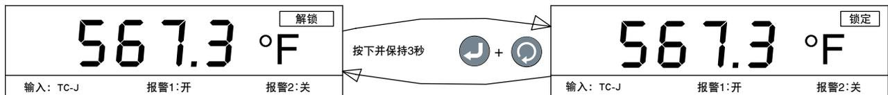
图9. 锁定 / 解锁流程图
