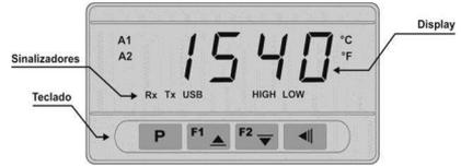
**Figura 05** - Identificação das partes do painel frontal
