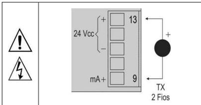
**Figura 04** – Exemplo de utilização da fonte de tensão auxiliar do indicador
