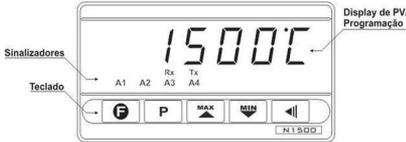
Fig. 10 - Identificação das partes do painel frontal
