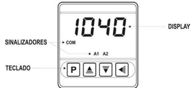
Figura 06 - Identificação das partes do painel frontal
