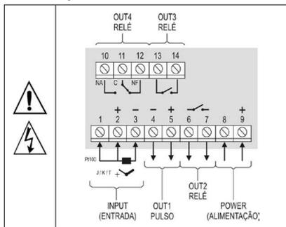
Fig. 01 - Conexões das entradas, saídas e alimentação
