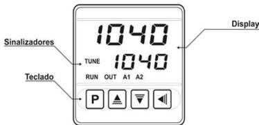
Fig. 02 - Identificação das partes do painel frontal
