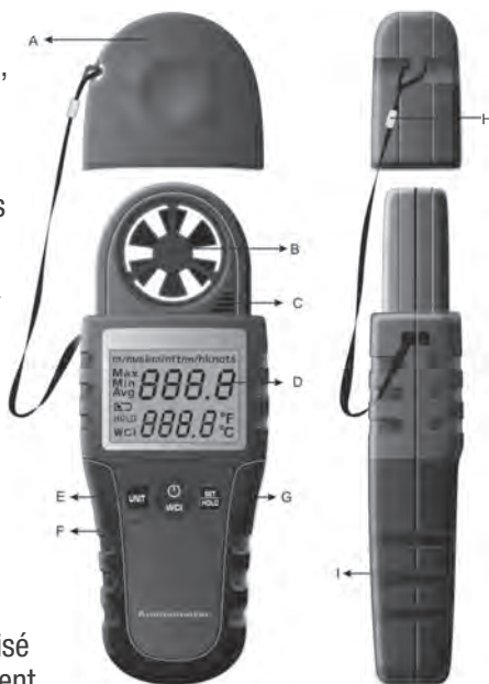
Fig. 1. Les contrôles, les indicateurs et les structures physiques du HHF-308
