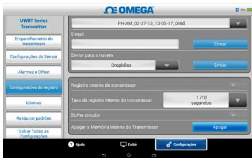
Figura 5-23. Opções de registro interno
