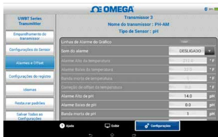
Figura 5-39. Visualizando as condições do alarme
