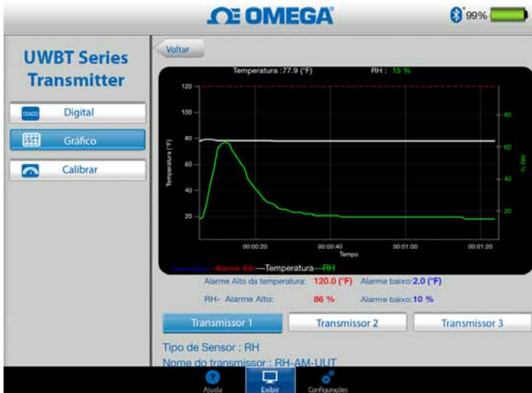
Figura 4-8. Gráfico de umidade relativa ao vivo com alarmes para alta e baixa
