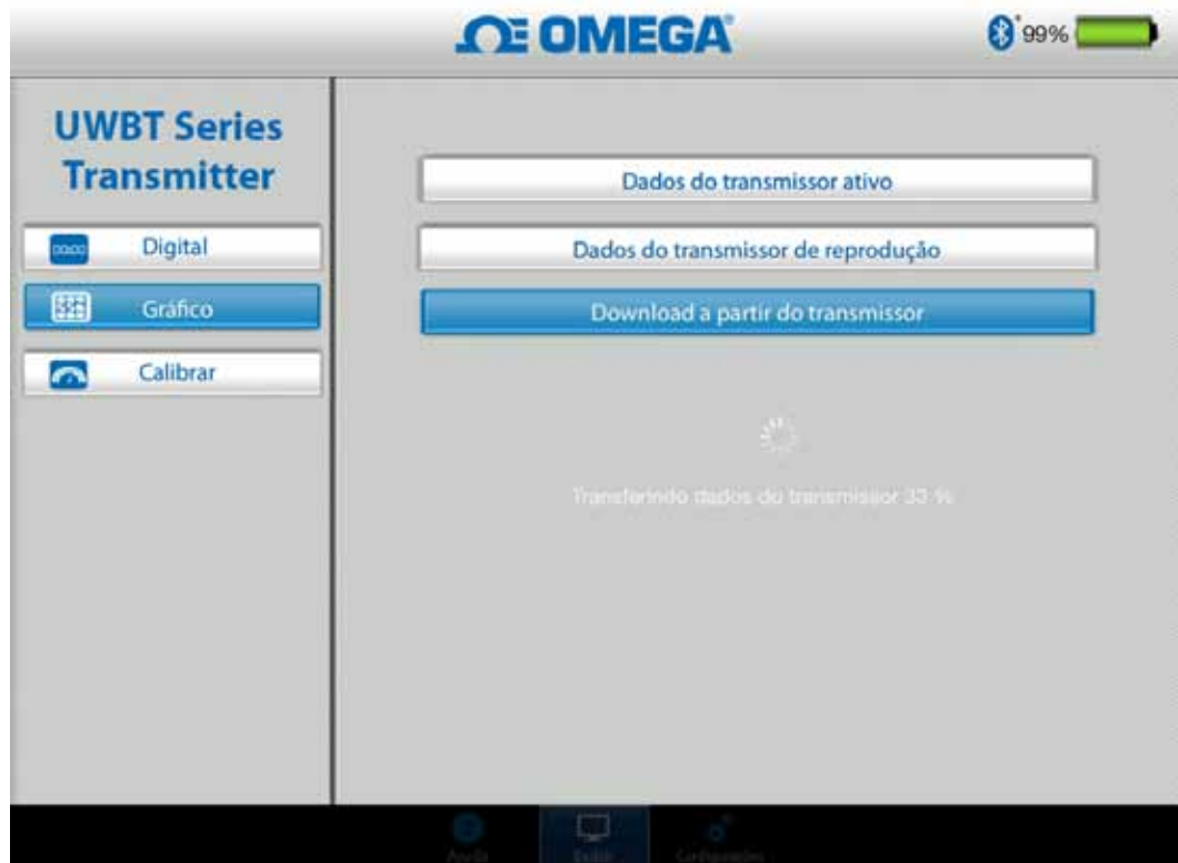
Figura 4-11. Baixando arquivos de registro do transmissor
