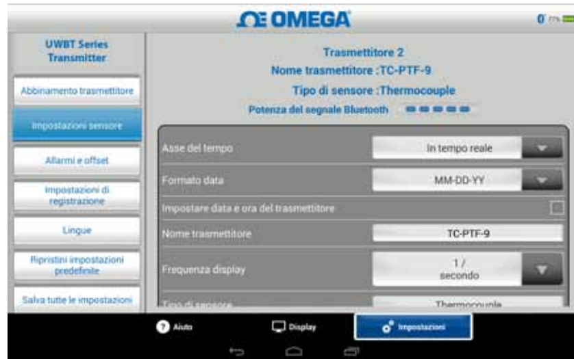
Figura 5-27. Schermata delle impostazioni del sensore termocoppia
