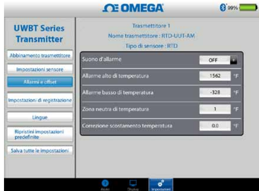
Figura 4-43. Zona neutra temperatura di 1 °F
