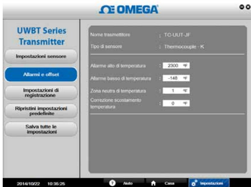
Figura 6-12. Schermata allarmi e scostamento del sensore termocoppia
