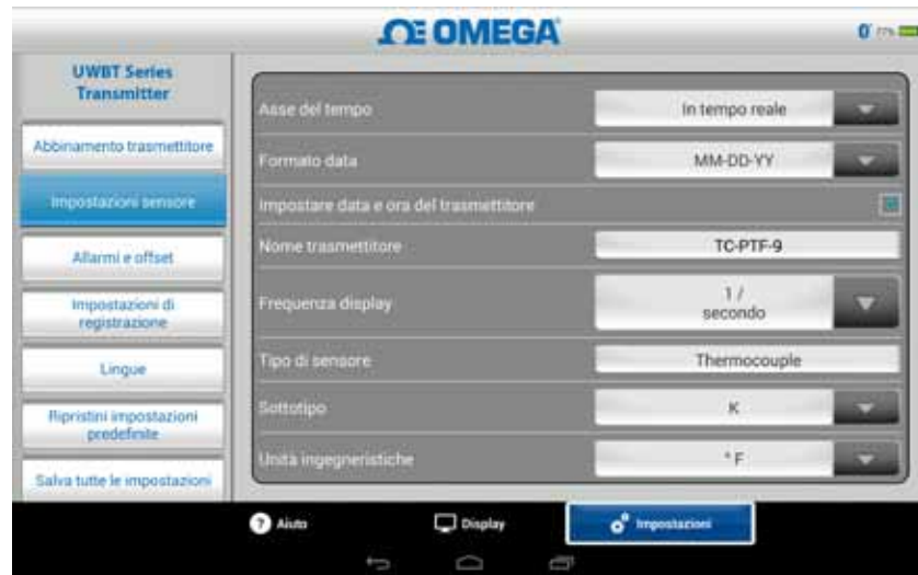
Figura 5-34. Visualizzazione del tipo e sottotipo del sensore per sensore a termocoppia
