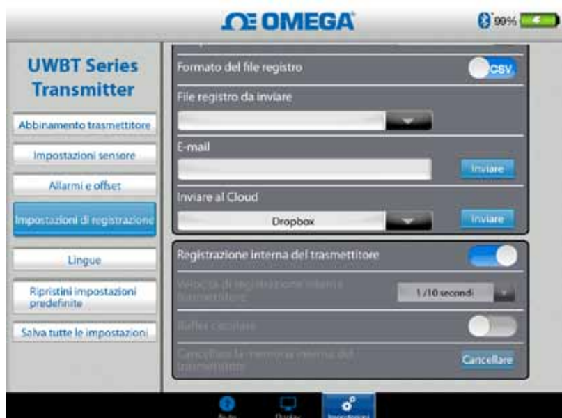
Figura 4-24A. Opzioni di registrazione interna (disabilitate quando la registrazione interna è attiva)
