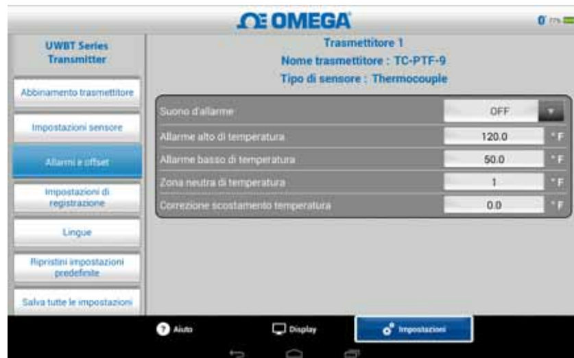
Figura 5-42. Zona neutra temperatura di 1 °F
