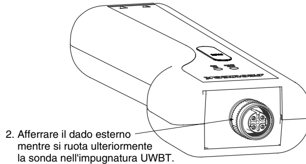
Figura 2-5. Connessione della sonda M12 all'UWBT
