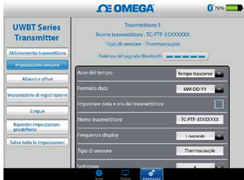
Figura 4-28. Schermata delle impostazioni del sensore termocoppia
