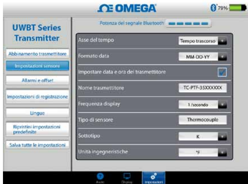
Figura 4-35. Visualizzazione del tipo e sottotipo del sensore per sensore a termocoppia
