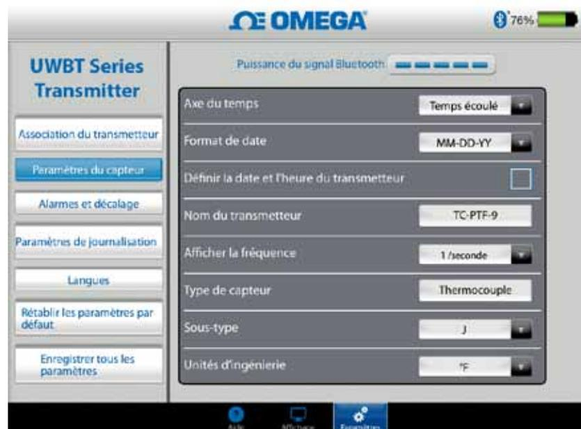
Figure 4-31. Affichage du nom et du type de capteur
