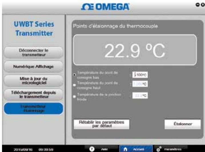
Figure 6-7. Étalonnage du modèle thermocouple
