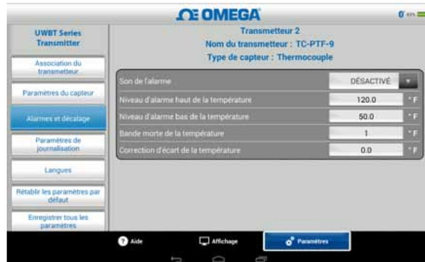
Figure 5-42. Bande morte de la température de 1 °F ( $-17,22\text{ °C}$ )
