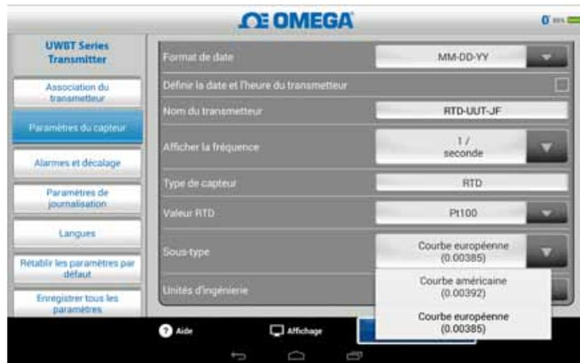
Figure 5-36. Sélection du sous-type de capteur RTD
