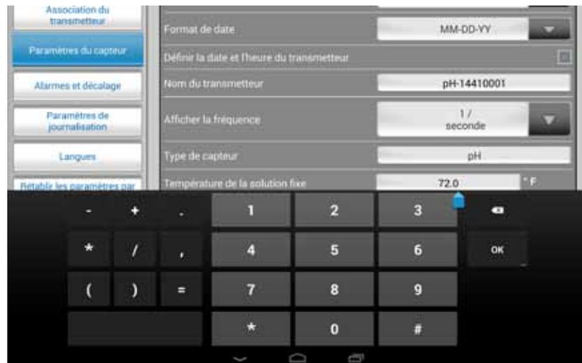
Figure 5-37. Réglage de la température fixe de la solution
