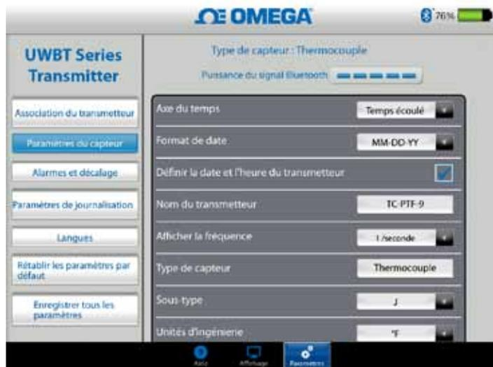
Figure 4-33. Paramètres de la date et de l'heure de l'appareil
