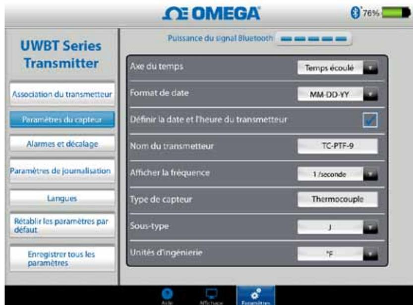
Figure 4-35. Affichage du type et du sous-type de capteur pour le capteur de thermocouple
