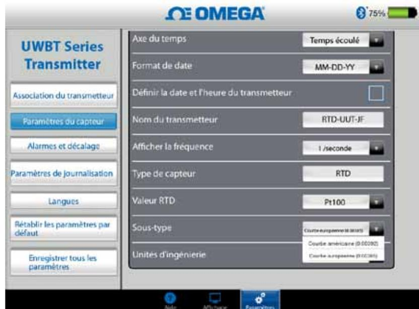
Figure 4-37. Sélection du sous-type de RTD
