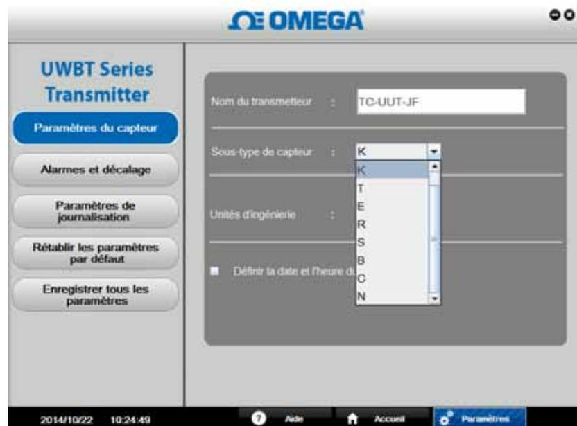
Figure 6-10. Écran des paramètres pour un capteur de thermocouple
