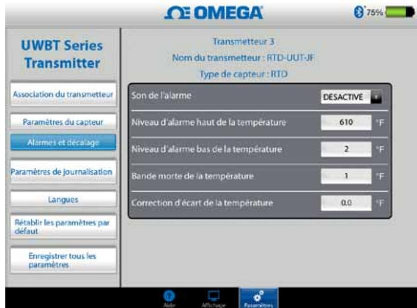
Figure 4-43. Bande morte de la température de 1 °F (-17,22 °C)
