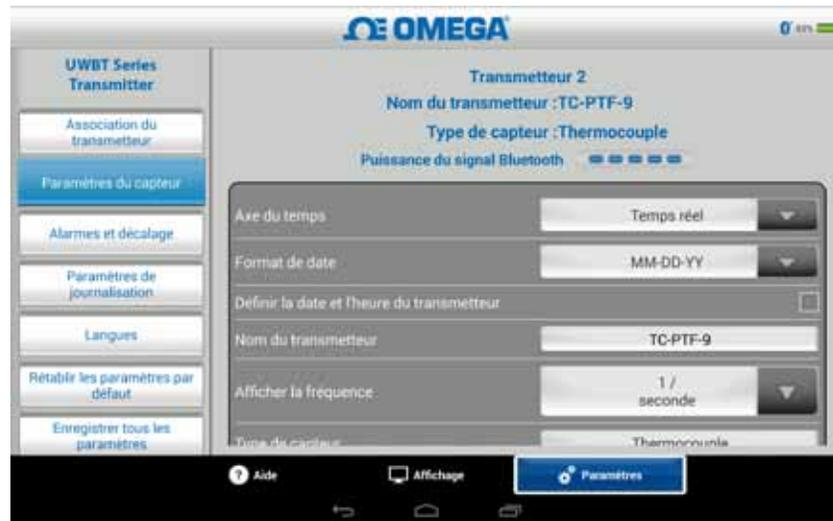
Figure 5-27. Écran des paramètres pour un capteur de thermocouple
