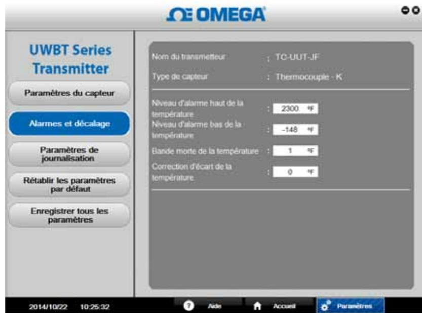
Figure 6-12. Écran des alarmes et décalage du thermocouple
