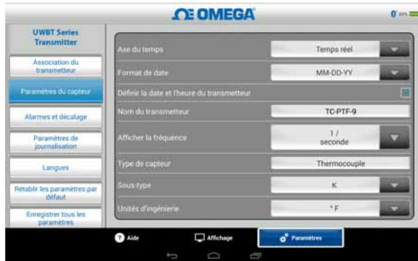
Figure 5-34. Affichage du type et du sous-type de capteur pour le capteur de thermocouple
