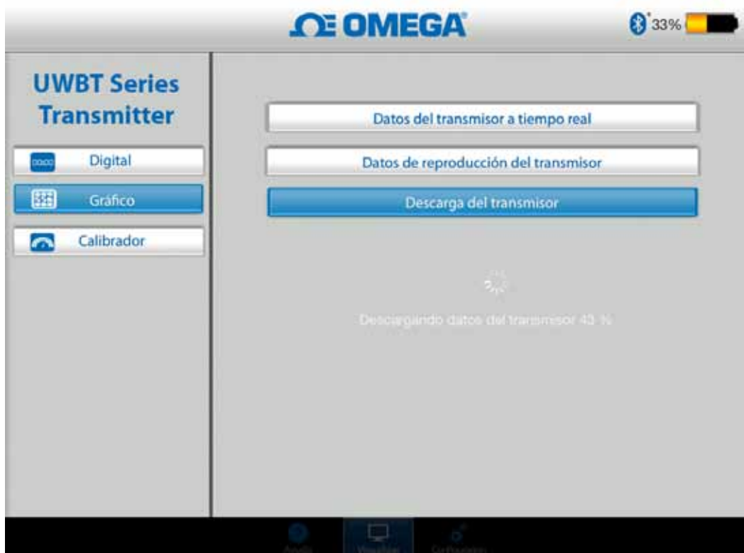
Figura 4-11. Descargar archivos de registro del transmisor
