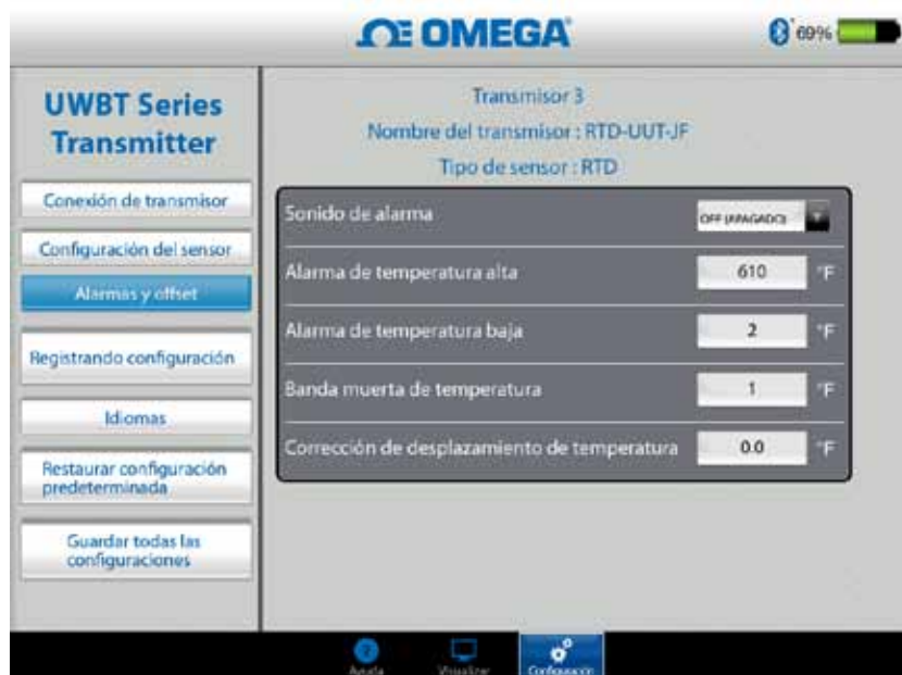
Figura 4-42. Entrada para los valores de temperatura
