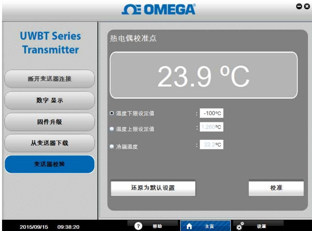
图 6-7. 热电偶型号校准
