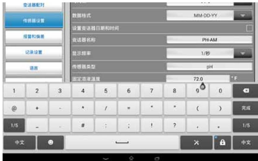
图5-37. 设置溶液的固定温度
