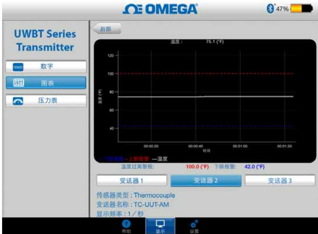
图4-7. 实时温度图，带上下限报警
