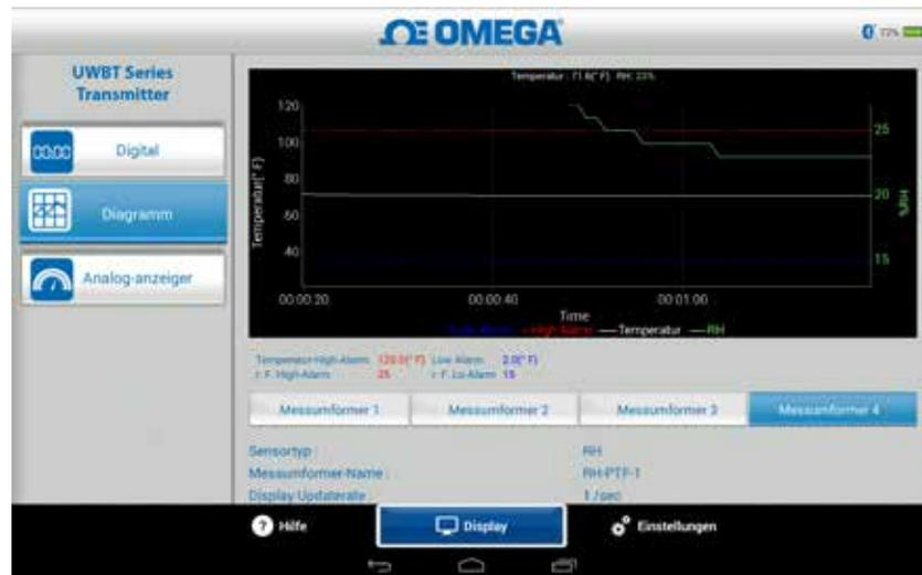
Abbildung 5-7. Live-Diagramm für relative Feuchte mit High- und Low-Alarmen
