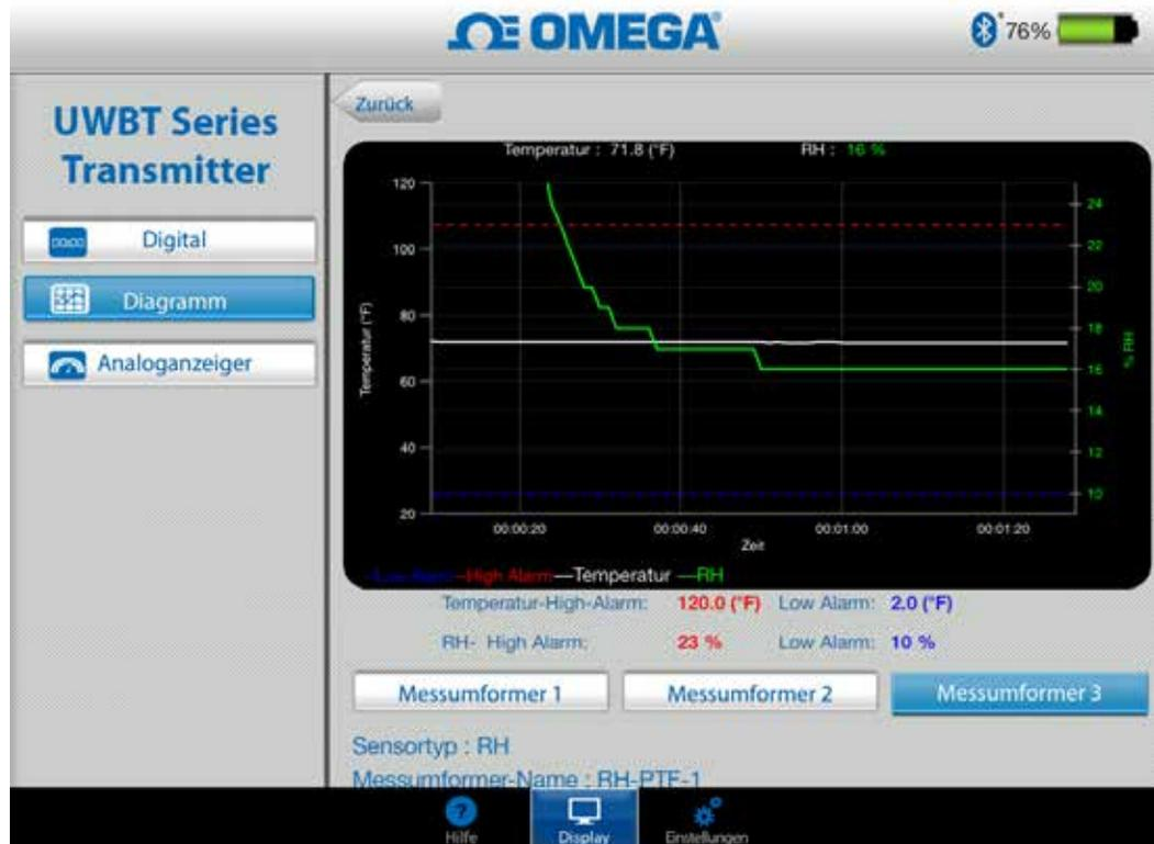
Abbildung 4-8. Live-Diagramm für relative Feuchte mit High- und Low-Alarmen
