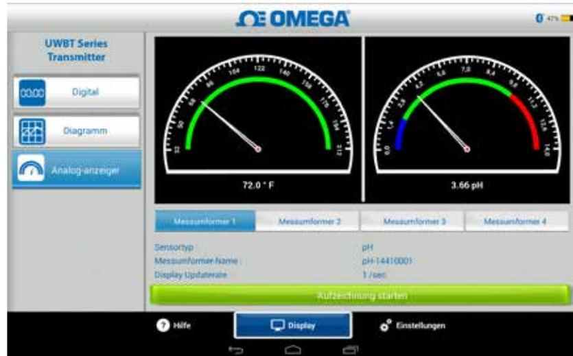
Abbildung 5-15. pH- und Temperatur-Analoginstrument
