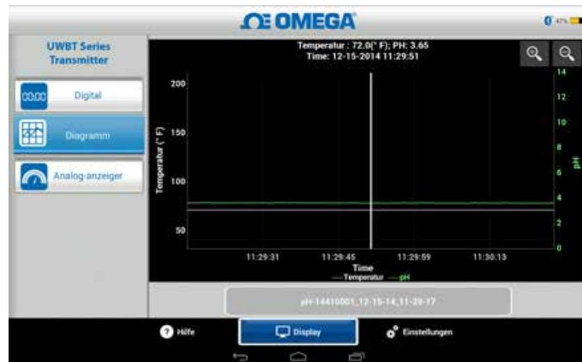
Abbildung 5-9. pH-Sensormesswerte zurücklesen und als Diagramm darstellen
