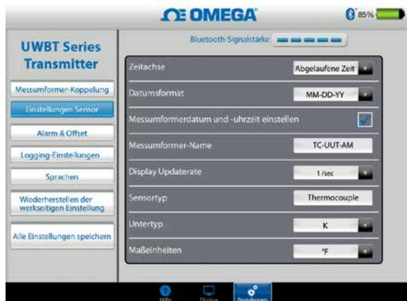
Abbildung 4-34. Ändern des Messumformer-Namens
