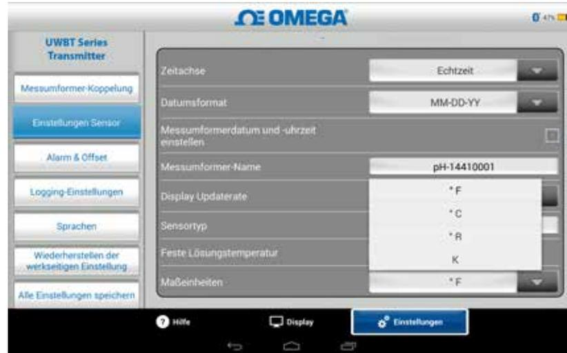
Abbildung 5-38. Einstellen von Temperatureinheiten
