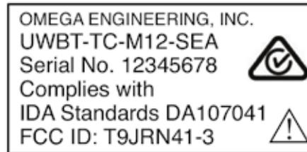
Abbildung 9-5. Beschriftung hinten für UWBT\*\*SEA, für die Verwendung in Singapur und Australien zertifiziert.
