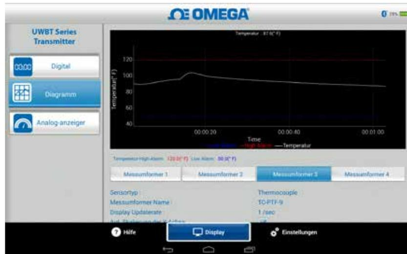
Abbildung 5-6. Live-Diagramm für Temperaturen mit High- und Low-Alarmen
