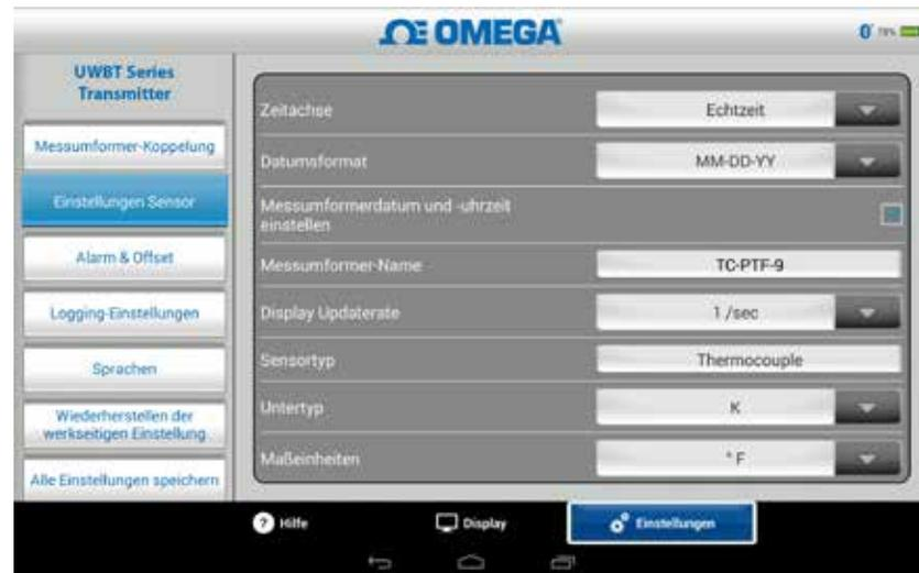
Abbildung 5-34. Anzeigen von Sensortyp und Untertyp für Thermoelementfühler
