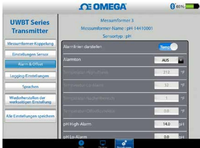
Abbildung 4-40. Anzeigen von Alarmzuständen
