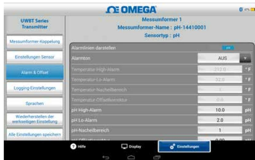
Abbildung 5-39. Anzeigen von Alarmzuständen
