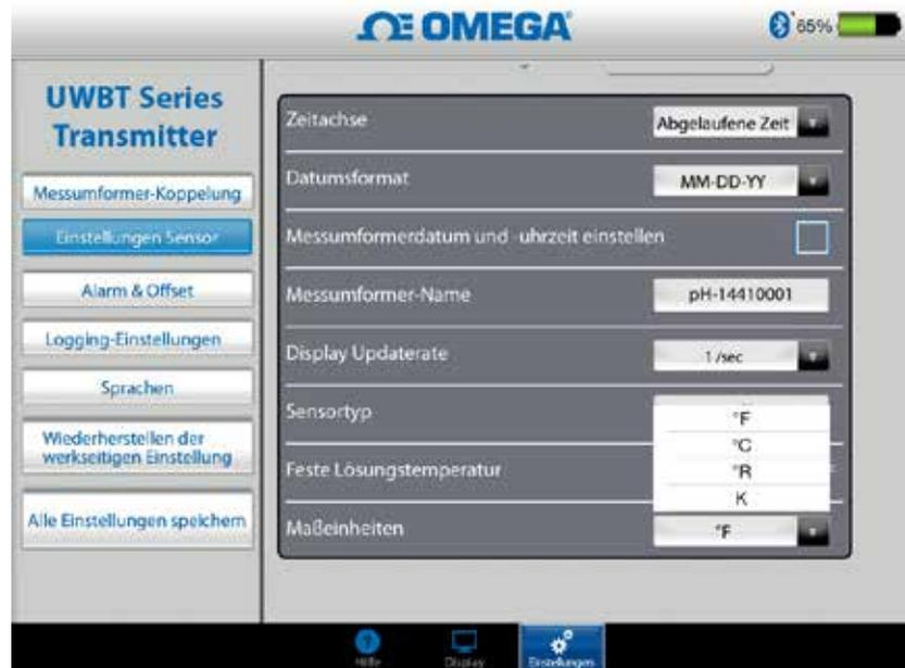
Abbildung 4-39. Einstellen von Temperatureinheiten
