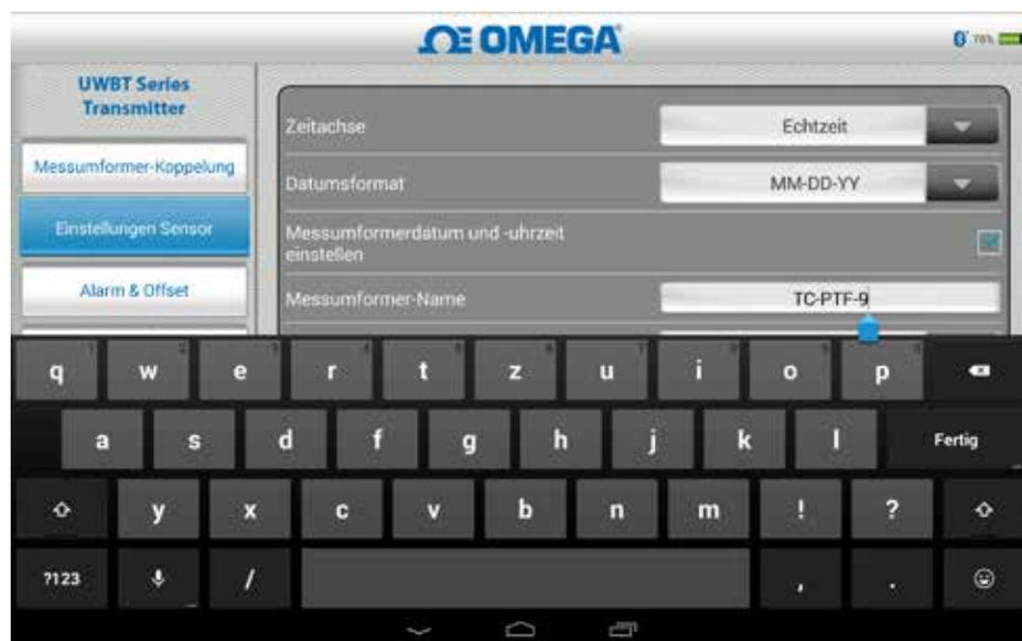
Abbildung 5-33. Ändern des Messumformer-Namens
