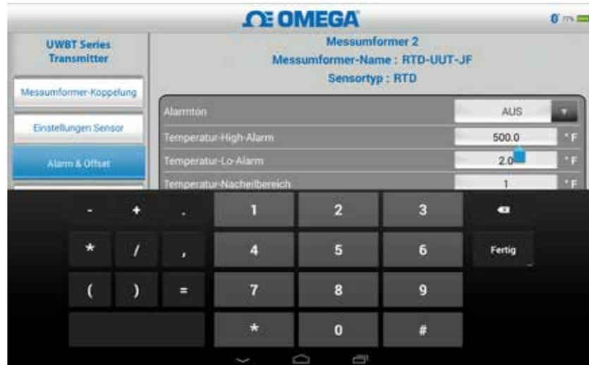
Abbildung 5-41. Tastatureingaben für Temperaturwerte
