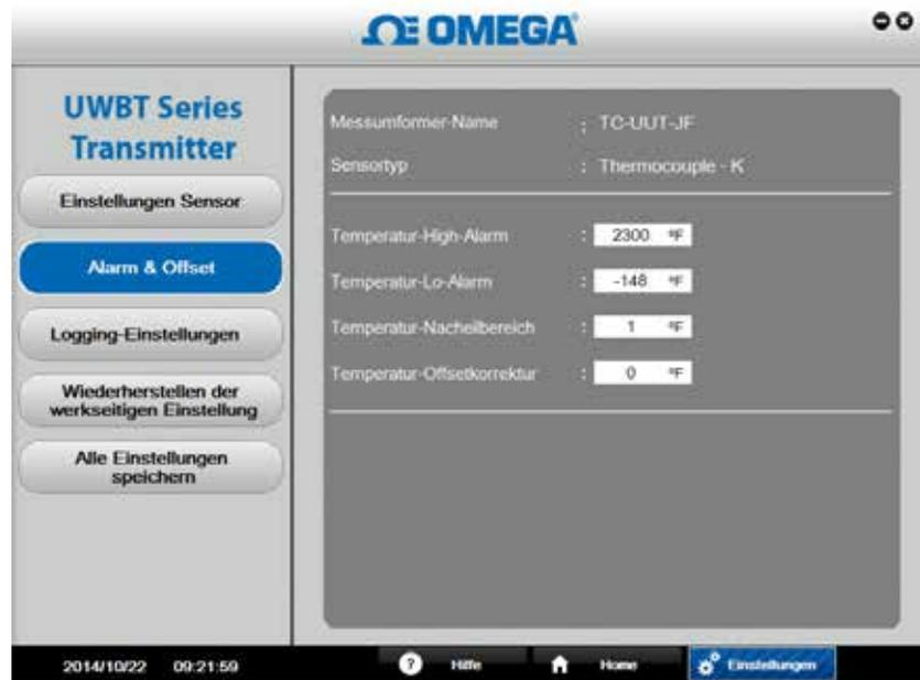
Abbildung 6-9. Bildschirm „Alarmer und Offset“ für Thermoelemente
