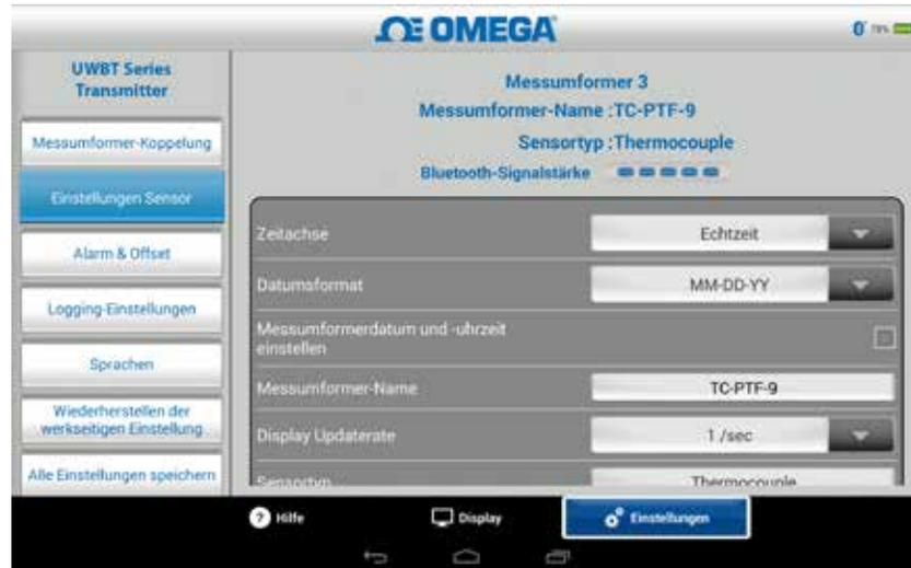
Abbildung 5-27. Bildschirm „Thermoelement-Sensoreinstellungen“
