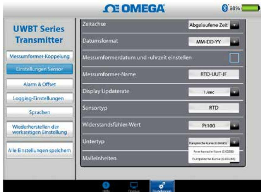
Abbildung 4-37. Auswählen des Widerstandsfühler-Untertyps
