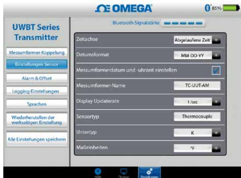
Abbildung 4-35. Anzeigen von Sensortyp und Untertyp für Thermoelementfühler
