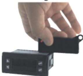
Le CN-Config-Module est équipée de batterie interne ayant une autonomie d'environ 1 000 utilisations. Insérer le CN-Config-Module et appuyer sur la touche de programmation. Pendant l'écriture des paramètres le voyant rouge, à la fin de la procédure s'allume en vert. IL
