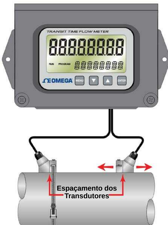
FIGURA 2.5 – POSICIONAMENTO DO TRANSDUTOR
