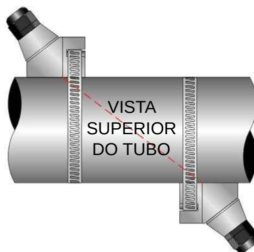
FIGURA 2.13 – INSTALAÇÃO DE TRANSDUTOR COM MONTAGEM EM Z
