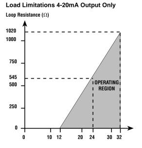
LOOP SUPPLY VOLTAGE  $V_{min} = 12V+[.022A^*R_L)]$
