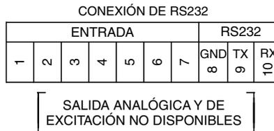
**Figura 2-6. Conexiones de RS232**
