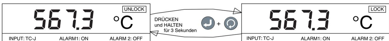
Abbildung 3-12. Flussdiagramm zum Sperren/Entsperren
