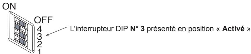
Figure 3.1 Interrupteur DIP à 4 positions sur la face inférieure du récepteur
