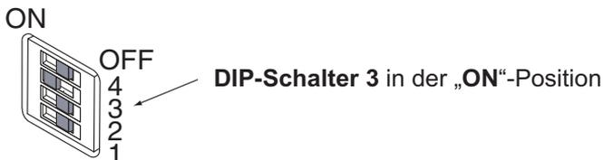
**Abbildung 3.1 4-facher DIP-Schalter an der Empfängerunterseite**
