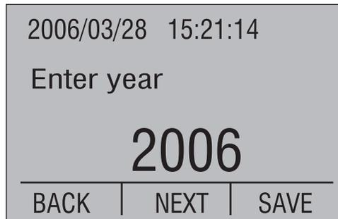
Anfangs werden in der oberen Anzeigenzeile genau die Werte für Datum und Uhrzeit vom Zeitpunkt der ersten Anzeige dargestellt. Anschließend zeigt die Seite statisch Ihre Eingaben an. Die Uhr wird erst wieder aktualisiert, nachdem Sie die Funktionstaste SAVE betätigt haben. Für eine genaue Einstellung empfehlen wir, die Uhrzeit auf die nächste volle Minute und die Sekunden auf Null einzustellen. Warten Sie ab, bis die
