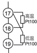
上图为电桥法测量温差的接线图，每个 Pt100 用 2 线连接，但 4 线电阻应相等，M1 位置应安装 J21 模块。
