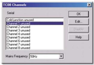
8. Doppelklicken Sie im Kanalfenster des TC-08 auf den unverwendeten Kanal 1. Das Dialogfeld "Edit TC08 Channel" (TC-08-Kanal bearbeiten) wird angezeigt:
