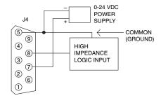
DRIVING A HIGH IMPEDANCE INPUT (PULL HIGH/DRIVE LOW)
