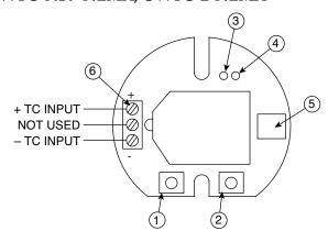
Figure 4-2A. Thermocouple Version
