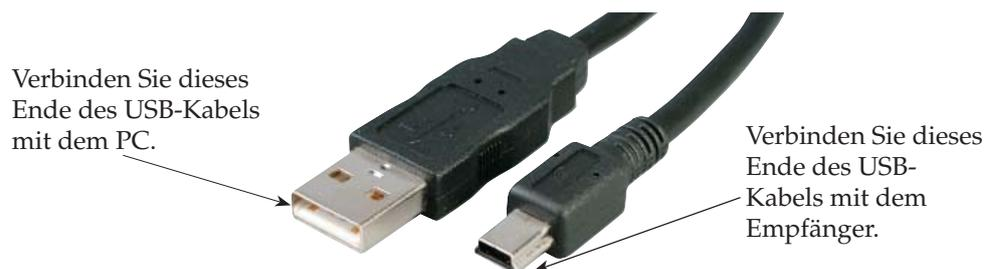
Abbildung 4-2C. Anschließen des Geräts
