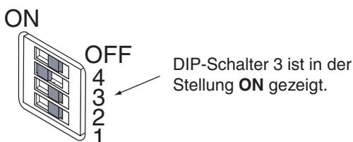
**Abbildung 3.2** DIP-Schalter an der Unterseite des iServers
