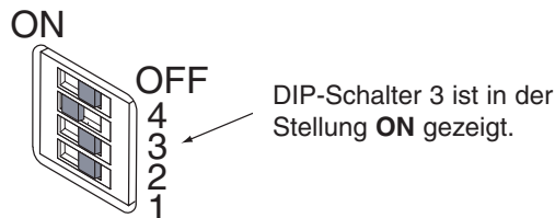
Abbildung 3.2 DIP-Schalter an der Unterseite des iServers
