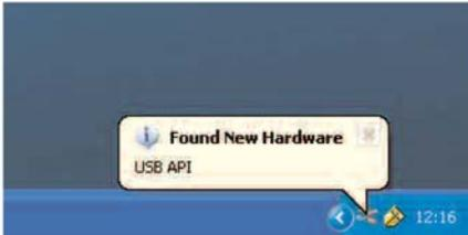
1. Stecken Sie den OM-EL-USB-Datenlogger in den USB-Anschluss Ihres Computers ein. Jetzt sollten automatisch die folgenden Anzeigen erscheinen. Während der Installation bezeichnet XP den OM-EL-USB-Datenlogger als „USB API“ und „F32x Express USB-Gerät“.
