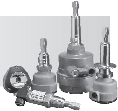
As Chaves de Nível Vibratória da Série LTU-2000, usam um cristal piezo-resistivo que vibra em uma frequência pré-definida, e é inserido dentro de um dispositivo (garfo) em forma de diapasão. Quando o garfo é encoberto por um líquido esta frequência se altera e é detectada por um circuito eletrônico que é convertido em uma saída ( Relé ou PNP/NPN) dependendo do Modelo.
