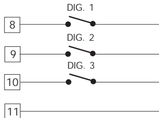
Fig. 9.A - LOGIC INPUTS DIG 1, 2, 3 WIRING
