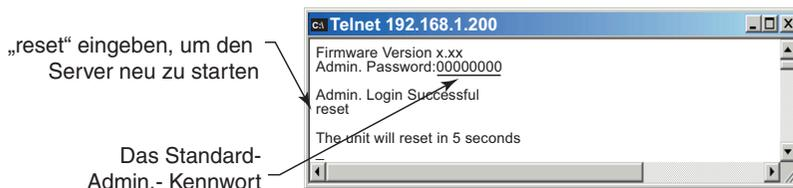
**Abbildung 3.3 Telnet-Login am iServer**
