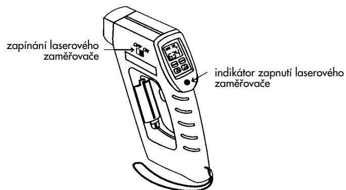
Obrázek 2-2. série OS530 se zabudovaným kruhovým laserovým zaměřováním.
