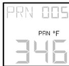
Le pyromètre peut envoyer les données de température vers une imprimante série en mode RS-232 par l'intermédiaire d'une prise jack et d'un câble RS-232.
