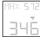
température maximale depuis le début de la série de mesures (après une action sur le déclencheur).
