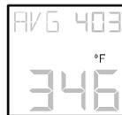
température moyenne vraie depuis le début de la série de mesures La température moyenne en fonctionnement continu est précise pendant un temps limité (reportez-vous aux spécifications) Cependant, on peut utiliser AVG (température moyenne) indéfiniment lorsque le pyromètre fonctionne par intermittence.
