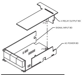
Figure 5-8. 4-Relay Option Board
