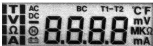
L'afficheur LCD complet comporte le mode, l'unité en vigueur, la statut de la fonction vocale, l'état du capteur, la mémoire d'affichage et l'alarme de pile (montré ci-dessus à échelle réduite).
