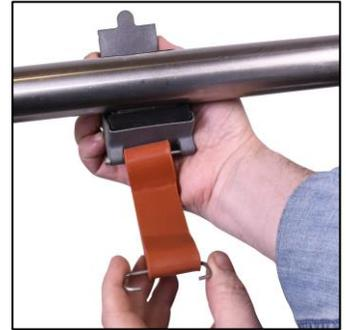
**Schritt 2:** Setzen Sie die Klammer in die Kanäle an der Seite der Schließe ein.
