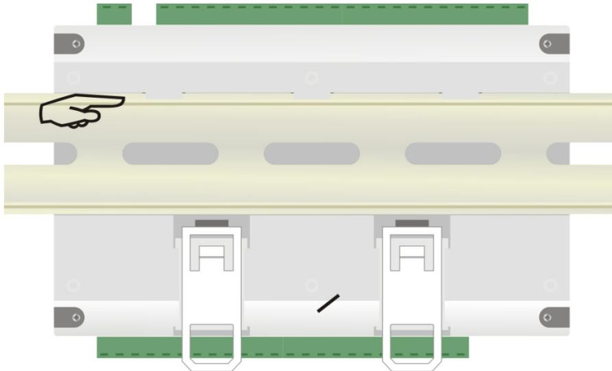
Fig. 02 - Modo de instalação em trilho DIN
