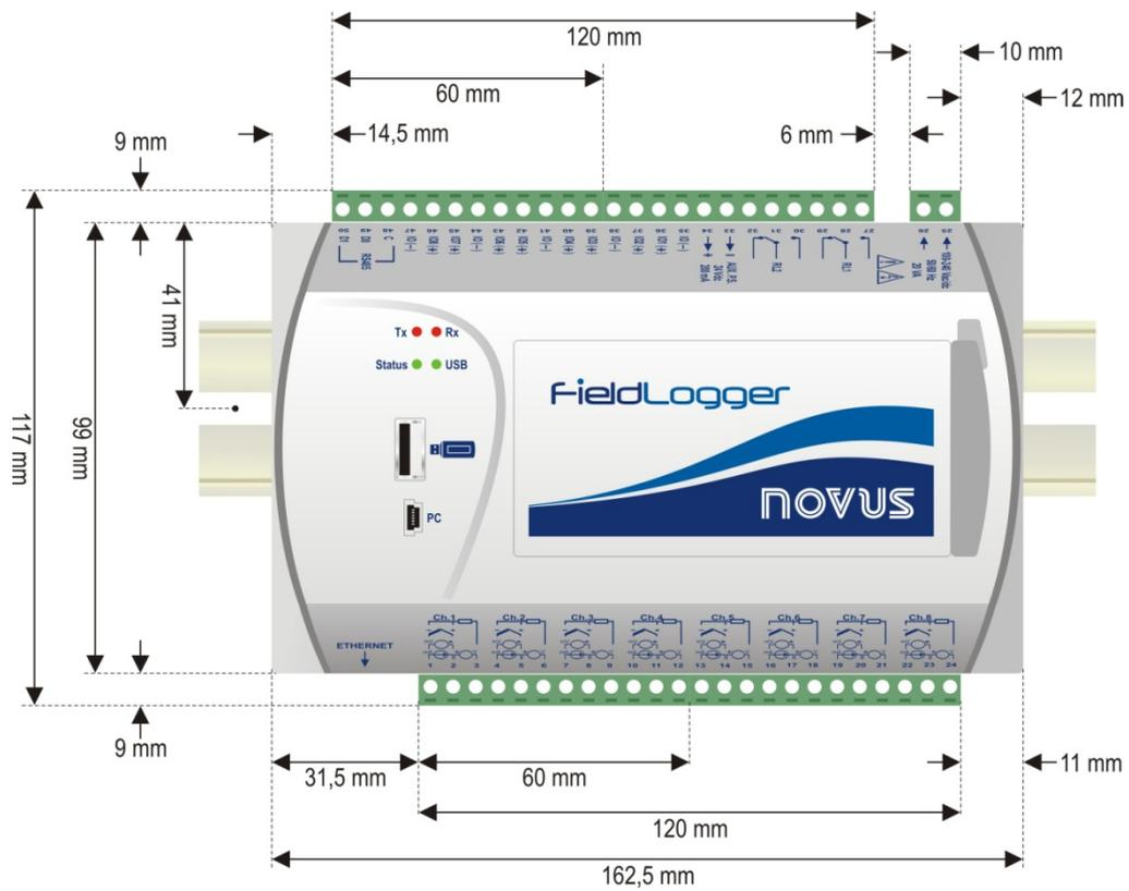
Fig. 04 – Dimensões do *FieldLogger* sem módulo IHM
