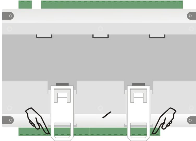
Fig. 01 – Modo de instalação em trilho DIN
