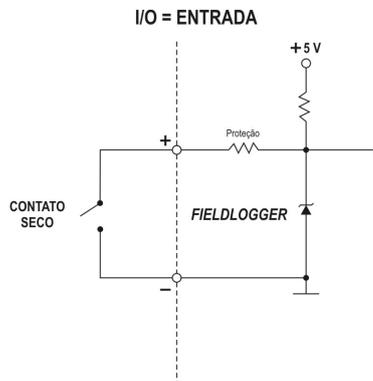
Fig. 16 - Conexão contato seco
