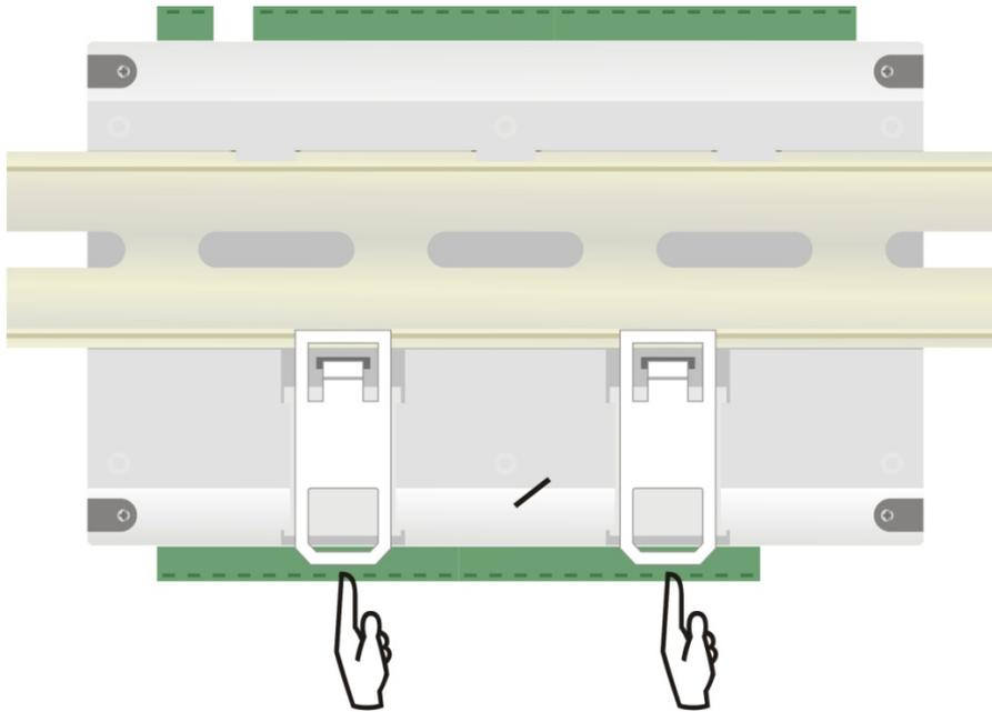
**Fig. 03** - Modo de instalação em trilho DIN
