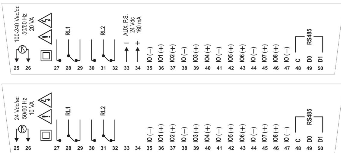
Fig. 13 – Conexões do lado superior para versão standard e 24 V
