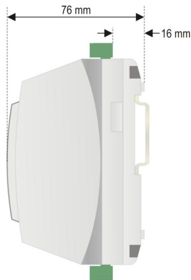
Fig. 07 – Dimensões da lateral do *FieldLogger* com módulo IHM
