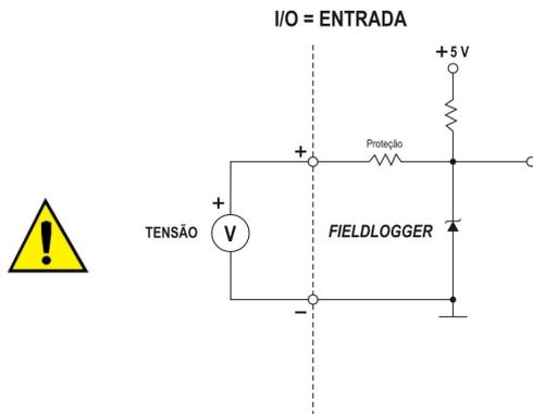
Fig. 15 - Conexão de tensão
