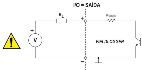
Fig. 18 - Conexão de uma carga à saída digital
