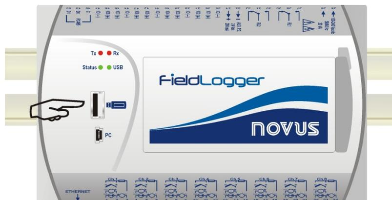
4. Recoloque o conector e o cabo de alimentação do dispositivo e, então, religue o **FieldLogger**. Os *LEDs* de *status* e da *USB* devem piscar juntos, indicando que o *bootloader* está em execução.
