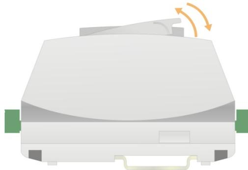
Fig. 11 – Retirando e instalando a *IHM* no *FieldLogger* (vista lateral)
