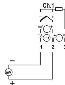
A conexão para os canais é feita nos terminais de acordo com a figura ao lado. Observe a correta polaridade de ligação.
