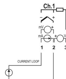
A conexão para os canais é feita nos terminais de acordo com a figura ao lado. Observe a correta polaridade de ligação.
