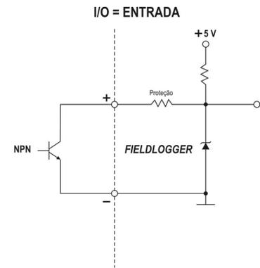
Fig. 17 - Conexão NPN
