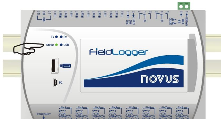
6. Se durante a cópia (gravação) do *firmware* do **FieldLogger** houver algum tipo de erro, este será indicado pelo LED de *status* que deixará de piscar periodicamente e mostrará repetidamente um padrão de piscagem conforme o erro ocorrido.
