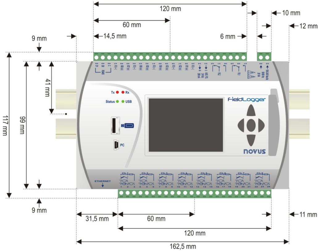
Fig. 06 – Dimensões do *FieldLogger* com módulo IHM
