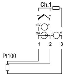
A conexão para os canais é feita nos terminais de acordo com a figura ao lado. A ligação com três fios desde o elemento sensor Pt100 até a entrada do **FieldLogger** garante o cancelamento do erro causado pela resistência dos fios. Os três fios devem ter mesma bitola e comprimento.
