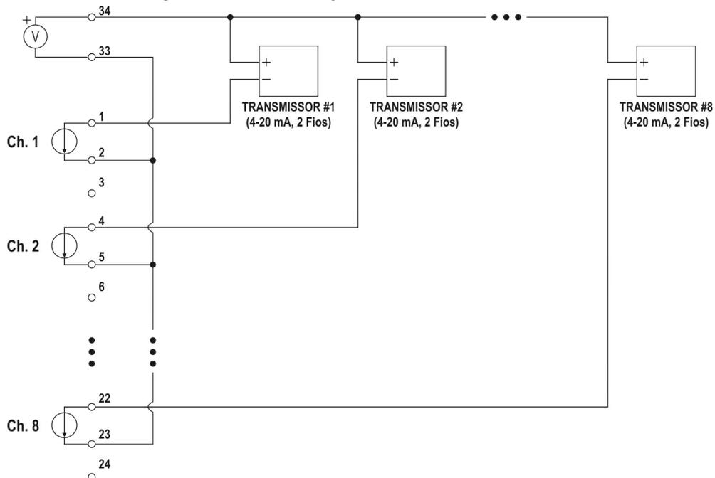
**Fig. 19** – Fonte auxiliar para alimentação de transmissores 4-20 mA (2 fios)
