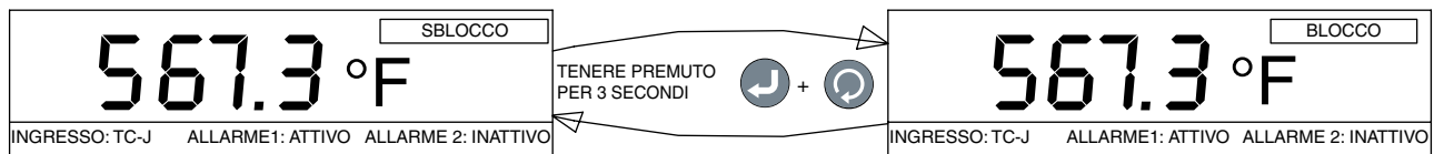
Figura 9. Diagramma di flusso blocco/sblocco
