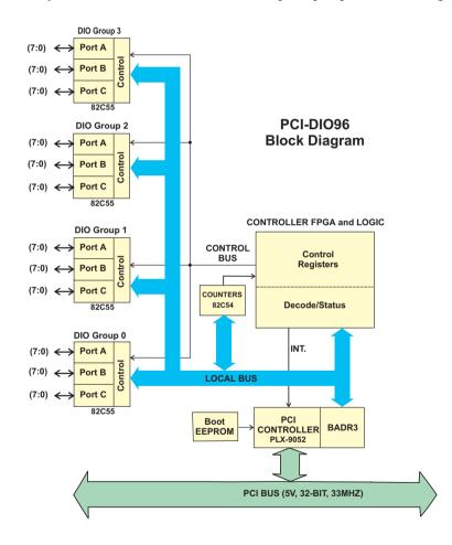
Figure 1-1. PCI-DIO96 Block Diagram
