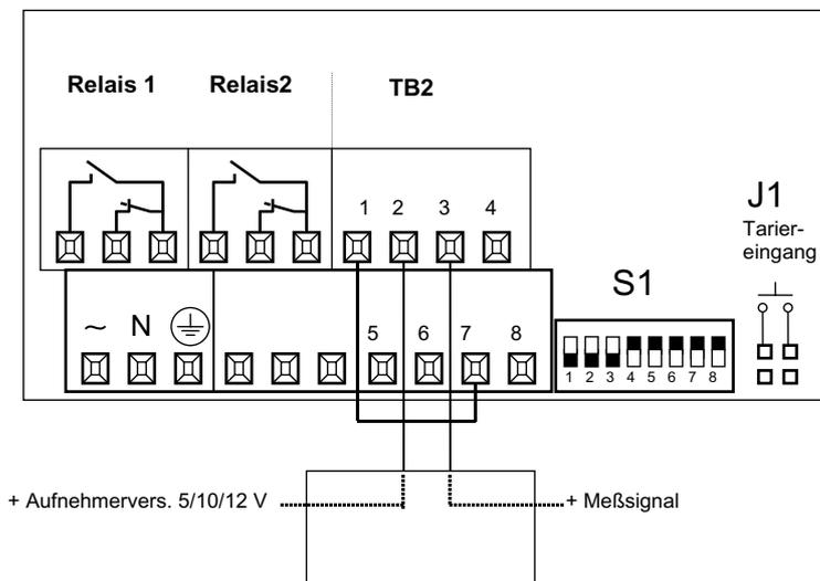
6.7 Anschluß 2-Draht-Aufnehmer mit Aufnehmersvers. 24 V und Stromausgang 0/4 - 20 mA
