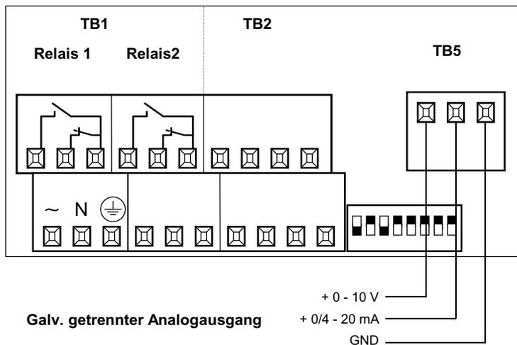
TB5 mit dem galv. getrennten Analogausgang 0 – 10 V bzw. 0/4 – 20 mA ist nur bei Modell INFCP-xx2 vorhanden
