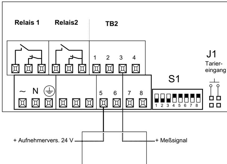
6.8 Anschluß 3-Draht-Aufnehmer mit Aufnehmersvers. 5/10/12 V und Stromausgang 0/4 - 20 mA
