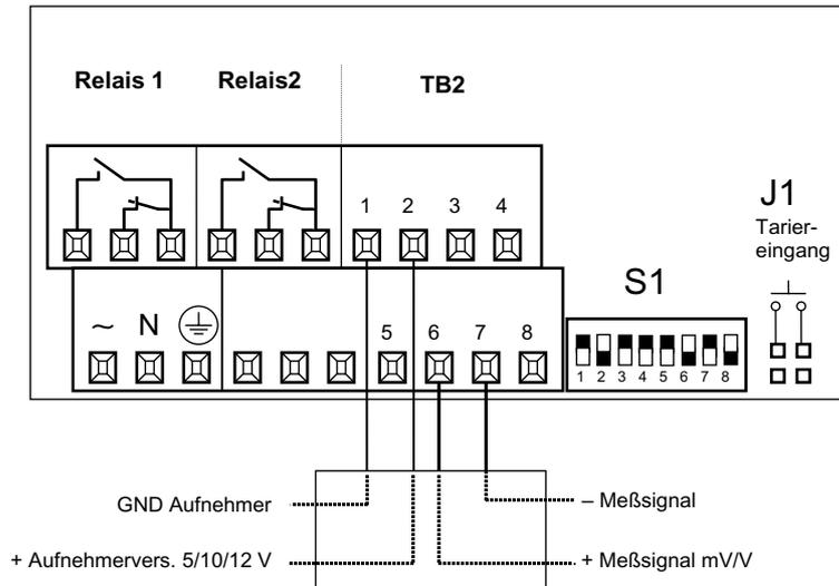
Bei extern versorgten DMS- oder 4-Draht-Aufnehmern die Aufnehmersversorgung TB2 Pin 1 und 2 nicht anschließen und die Aufnehmer extern versorgen.
