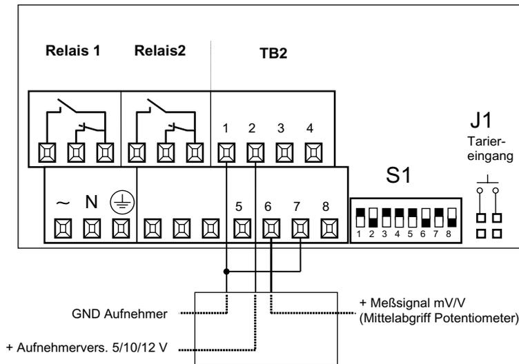
Beim Anschluß eines Potentiometers ergibt die Aufnehmersversorgung gleichzeitig die max. Signalspannung. Wählen Sie daher als Aufnehmersversorgung 10 V. Es ergibt sich damit eine Meßsignal von 0 – 10 V.
