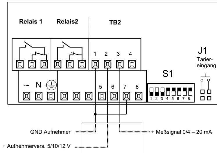
6.9 Anschluß 3-Draht-Aufnehmer mit Aufnehmersvers. 24 V und Stromausgang 0/4 - 20 mA
